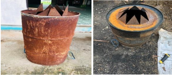
ภาพที่ 20 ถังเหล็กแบบยาว ขนาด 50 ลิตร ล้ำหรับเป็นท่อระบายควัน
