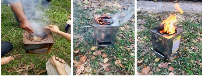
ภาพที่ 13 การเติมเชื้อเพลิงจากเศษฟืน และการลุกไหม้ของเชื้อเพลิงจากเตาชีวมวล
