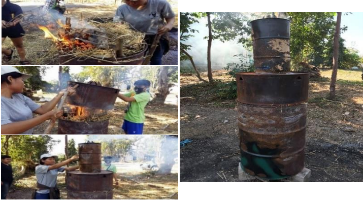
ภาพที่ 24 การจุดไฟ ปิดฝา และใส่ท่อระบายควัน
