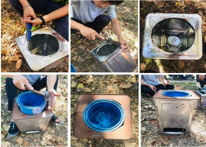
ภาพที่ 12 การวางตั้งสึบนฝาปิดเพื่อทำการวัดขนาดและตัดปั๊
