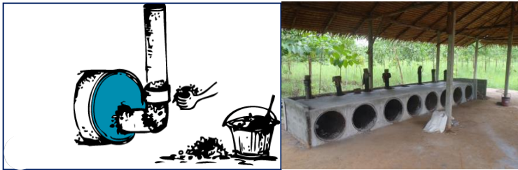
ภาพที่ 2 การต่อข้ออและใช้ดิน โคลนหรือปูนยารอยต่อระหว่างถังกับข้ออ และข้ออกับท่อตรง
