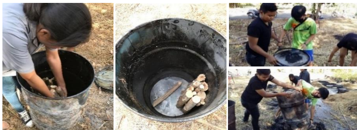
ภาพที่ 22 การบรรจุวัสดุที่จะผลิตถ่านชีวภาพลงในถังเหล็กขนาด 50 ลิตร
