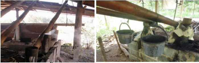
ภาพที่ 7 การเก็บน้ำล้นควันไม้ในระหว่างการเผาถ่าน
