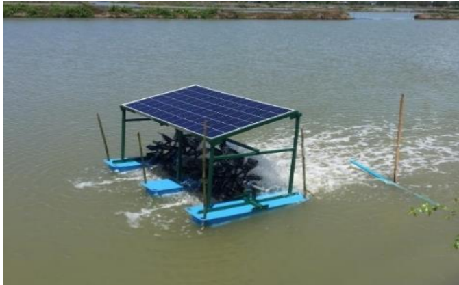
ภาพที่ 12 เครื่องตีน้ำพลังงานสะอาดระบบโซลาเซลล์
