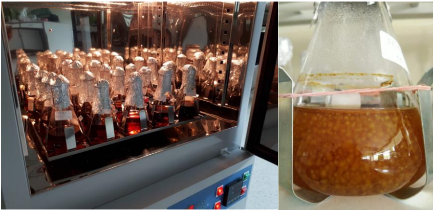
ภาพที่ 16 การเตรียมเส้นใยเห็ดตับเต่าในอาหารเหลวเพื่อใช้สำหรับหยอดใส่ในต้นกล้า
