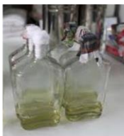
ขั้นตอนที่ 5 บรรจุในขวดปิดจุกสำลี หุ้มด้วยกระดาษ
