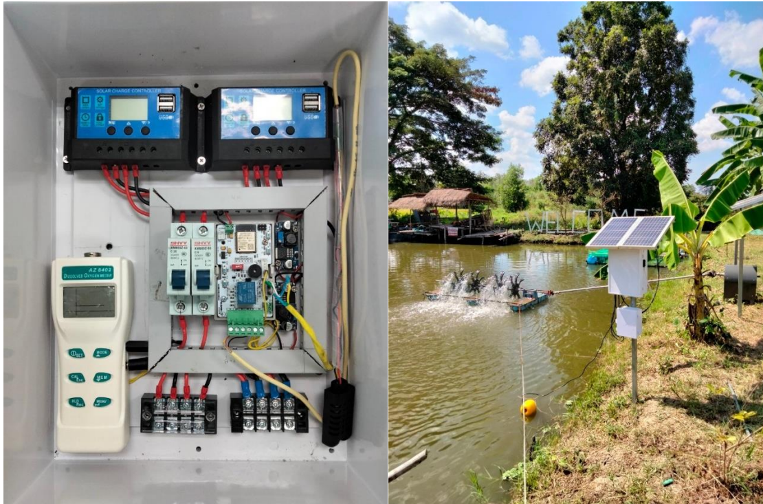
รูปที่ 6 ระบบตรวจวัดคุณภาพน้ำและสิ่งแวดล้อมบ่อปลา
