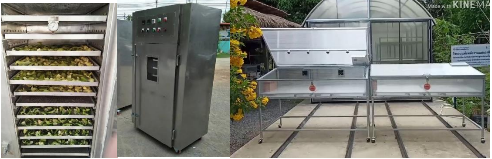
ภาพที่ 3.8 ตู้ไฟฟ้า และตู้แสงอาทิตย์
