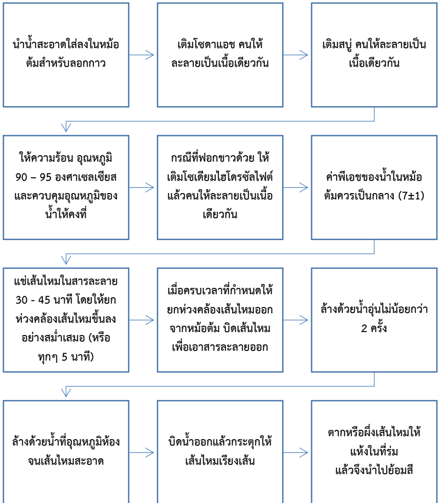
รูปที่ 2.15 ขั้นตอนการลอกกาวยาเส้นไหมด้วยสารเคมี
