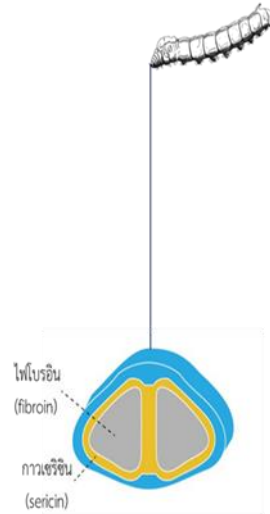
รูปที่ 2.4 ส่วนประกอบของไหมดิบ ที่มา: ขนิษฐา เจริญลาภ, 2564.
