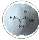
ตัวเร่งรัดการย้อมคราม (ไทโอยูเรียไดออกไซด์)
