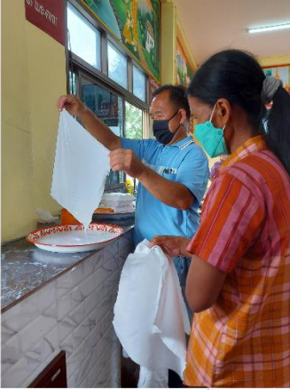
การเคลือบผ้าด้วยสารสะท้อนน้ำโดยการแช่
