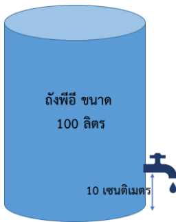
รูปที่ 5.20 ถังพักน้ำเสีย
