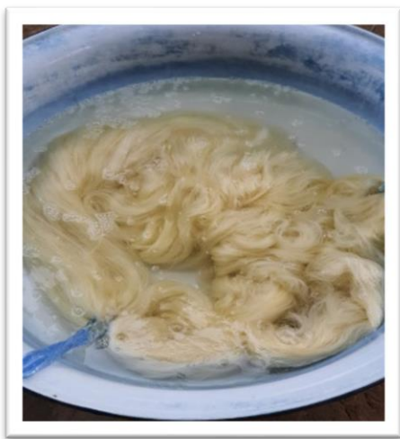
ภาพที่ 1.4 การปรับสภาพเส้นใยด้วยสารเพิ่มประจุบวก
