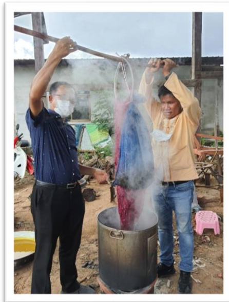
ภาพที่ 3.2 การย้อมเส้นใยให้ได้สีแดงจากครั่ง
