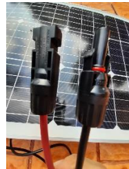
รูปที่ 2.20 การเชื่อมต่อแผง เซลล์แสงอาทิตย์ด้วยขั้วต่อ MC4
