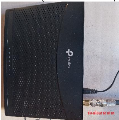
รูปที่ 3.3 การเชื่อมต่อเสาอากาศภายนอก กับอุปกรณ์เราเตอร์ 3G/4G
