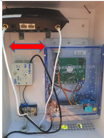
รูปที่ 5.12 การเชื่อมต่อเสาอากาศภายนอก
