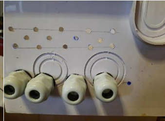
รูปที่ 2.14 การเจาะรูร้อยสายและระบายอากาศ
