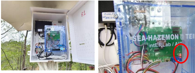
รูปที่ 5.14 อุปกรณ์โหมดเซ็นเซอร์และเราเตอร์ 3G/4G
