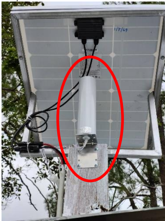
รูปที่ 5.12 การเชื่อมต่อเสาอากาศภายนอก
