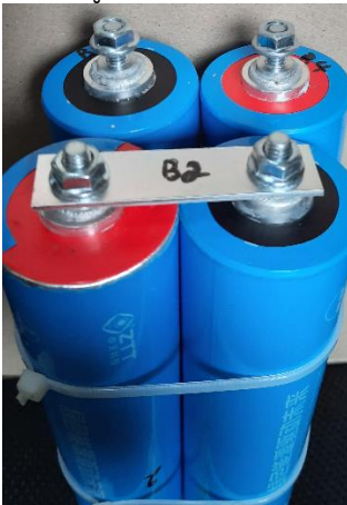
รูปที่ 2.9 แบตเตอรี่แบบลิเธียมไอออนฟอสเฟต (Lifepo4 battery)
