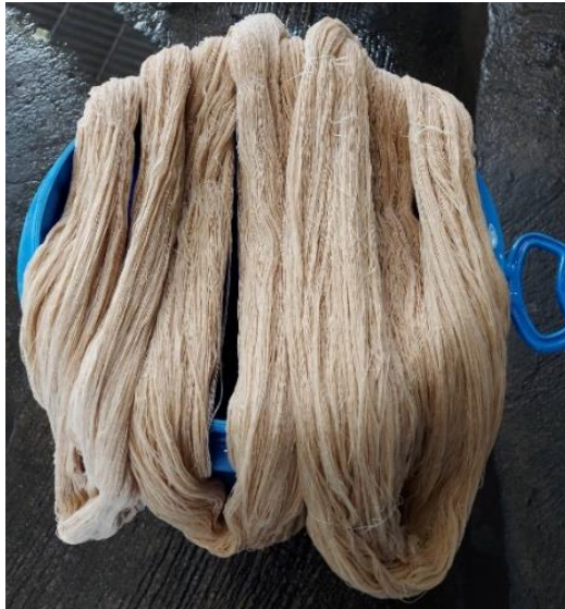
ภาพที่ 2.14 เส้นด้ายกัญชงที่ผ่านการชุบมัน
