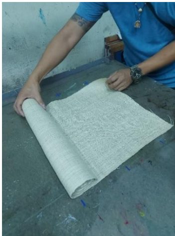
ภาพที่ 4.11 การปูผ้าลงบนโต๊ะพิมพ์
