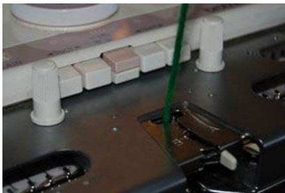
ภาพที่ 7.18 การใส่เส้นด้ายกับแขนป้อนเส้นด้าย
