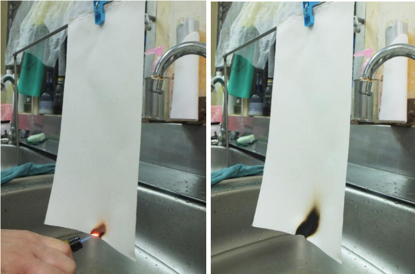
ภาพที่ 5.4 ผ้าฝ้ายที่ผ่านการตกแต่งด้วยสารหน่วงไฟ ไม่เกิดการลามไฟ
