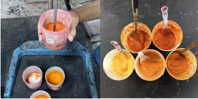
ภาพที่ 4.22 การผสมแป้งพิมพ์และสีพิมพ์จากเมล็ดค้ำแสดในอัตราส่วนต่าง ๆ
