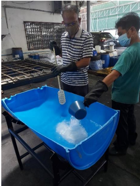
ภาพที่ 2.4 การละลายโซดาไฟเกล็ดในน้ำ
