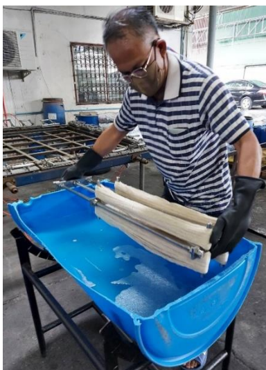
ภาพที่ 2.8 จุ่มเส้นด้ายกัญชงลงแช่ในสารละลายโซดาไฟ
