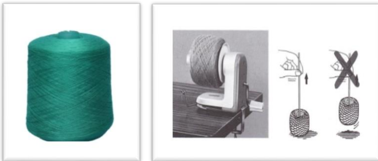
ภาพที่ 7.14 การกรอเส้นด้ายเป็นลูกด้ายและหลอดด้ายโคน
