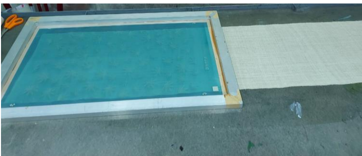
ภาพที่ 4.29 แม่พิมพ์สกรีนและผ้ากัญซุงพร้อมพิมพ์
