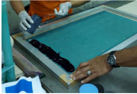
ภาพที่ 4.30 เทแป้งพิมพ์ต่างที่บิทมลงแม่พิมพ์
