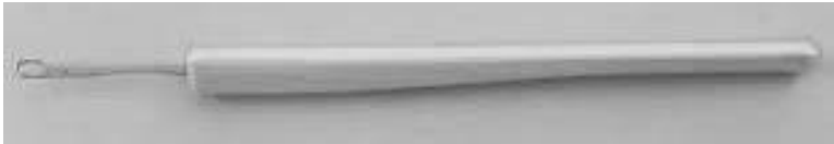
ภาพที่ 7.7 อุปกรณ์สำหรับเก็บห่วงถัก
