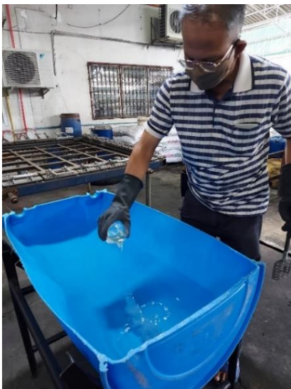
ภาพที่ 2.7 เติมสารช่วยเปียกลงในสารละลายโซดาไฟที่เย็นแล้ว
