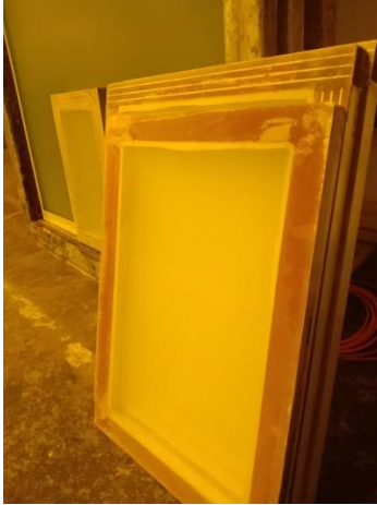
ภาพที่ 4.2 ผ้าสกรีนที่ถูกซึงตึงบนบล็อกสกรีน
