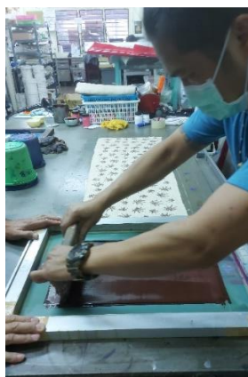
ภาพที่ 4.14 การพิมพ์สีฟักเมนท์ลงบนผ้ากัญชง
