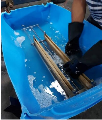
ภาพที่ 2.9 ปีบสารละลายโซดาไฟให้เข้าเส้นด้าย
