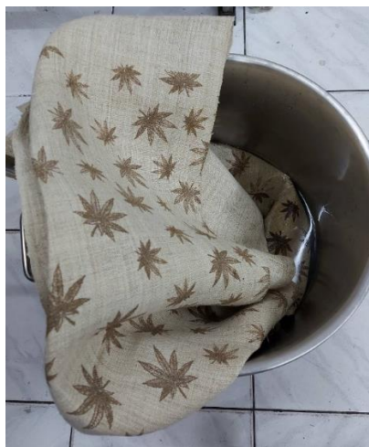
ภาพที่ 4.34 แซ่ผ้าพิมพ์ลงในสารละลายโซเดียมเมต้าไบซัลไฟท์
