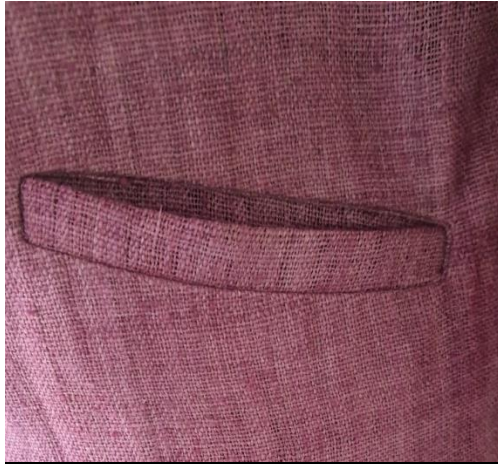
ภาพที่ 9.7 รูปแบบกระเป๋าเจาะแบบมีสาปจากผ้าใยกล้วยง
