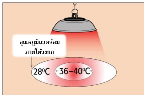
ภาพที่ 1.5 อุณหภูมิบริเวณใต้เครื่องกก
