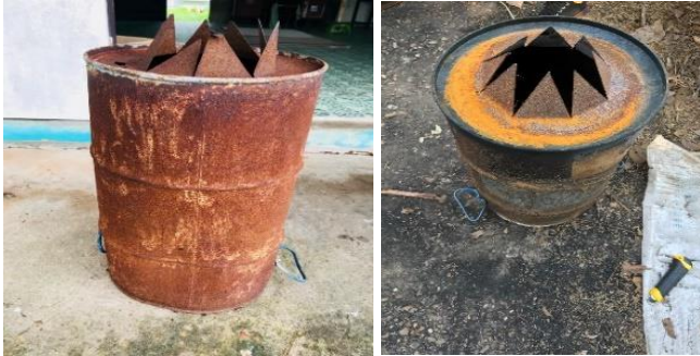
ภาพที่ 20 ถังเหล็กแบบยาว ขนาด 50 ลิตร สำหรับเป็นท่อระบายควัน
