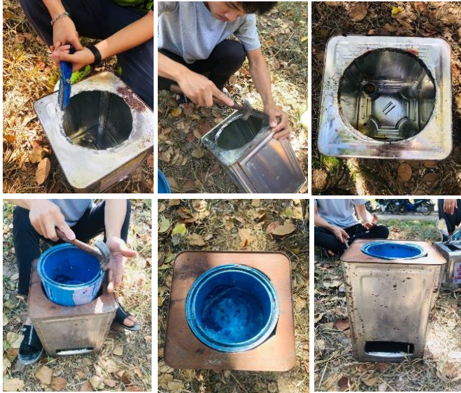
ภาพที่ 12 การวางถังสีบนฝापั๊มเพื่อทำการวัดขนาดและตัดปั๊ม
