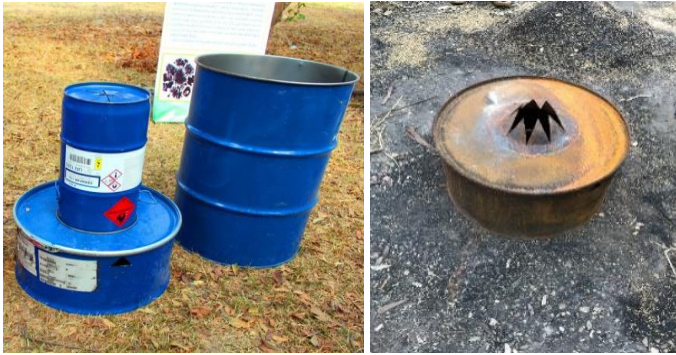
ภาพที่ 18 ถังเหล็กขนาด 200 ลิตร และฝาครอบปิดเตา
