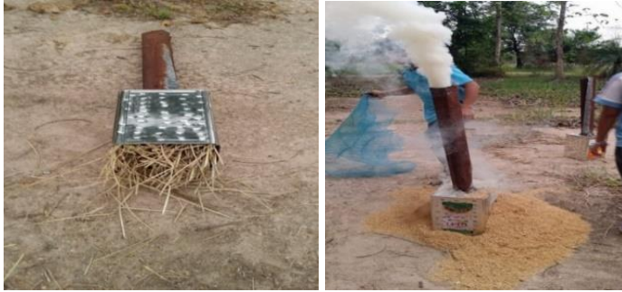
ภาพที่ 28 การใส่ฟางข้าวเพื่อเป็นเชื้อเพลิงในการเผา และการจุดไฟภายในบั้ง
