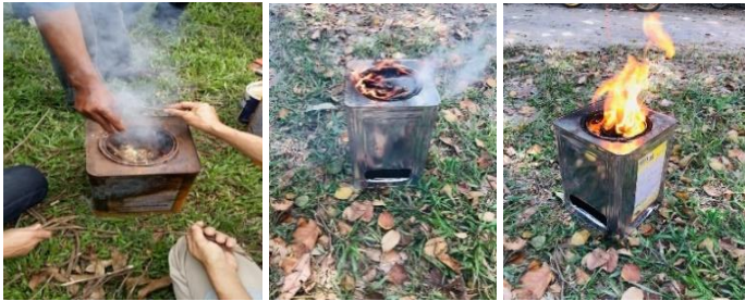
ภาพที่ 13 การเติมเชื้อเพลิงจากเศษพืช และการลุกไหม้ของเชื้อเพลิงจากเตาชีวมวล
