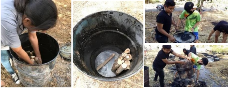
ภาพที่ 22 การบรรจุวัสดุที่จะผลิตถ่านชีวภาพลงในถังเหล็กขนาด 50 ลิตร
