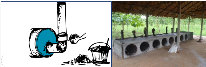
ภาพที่ 2 การต่อซ็องอและใช้ดินโคลนหรือปูนยารอยต่อระหว่างถังกับซ็องอ และซ็องอกับท่อตรง
