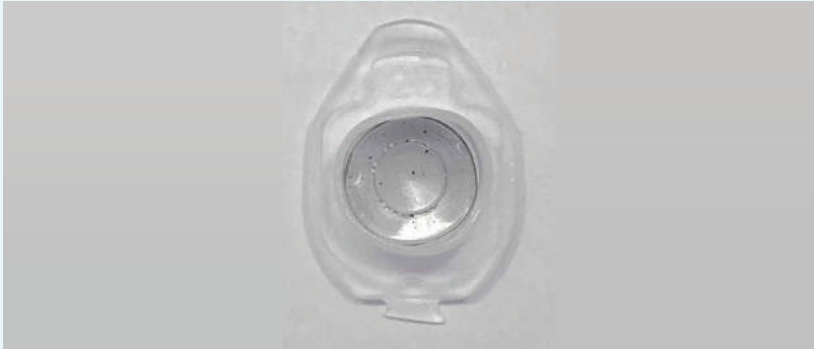
รูปที่ 7 แผ่นฟิล์มบางสำหรับรีดิวซ์ไอออนไนเตรทให้เป็นไอออนไนไตรท์
