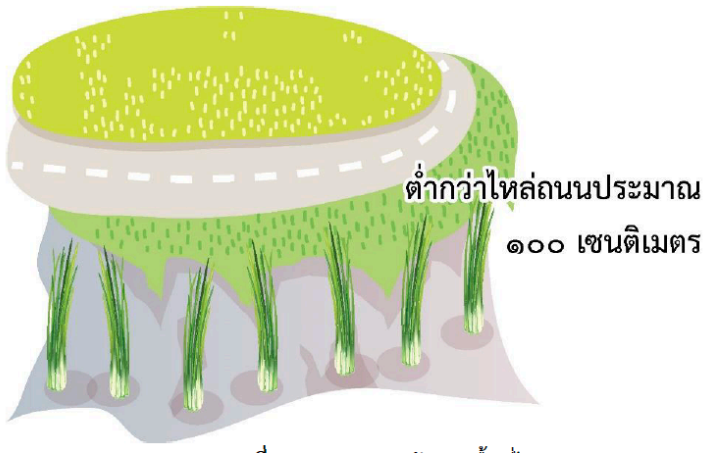
ภาพที่ 13 การปลุกหญ้าแฝกบนพื้นที่ไหล่ทางถนน
