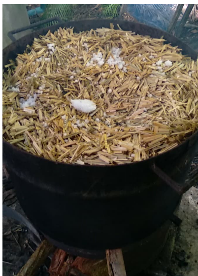
ภาพที่44 ใส่โซดาไฟในหม้อต้มเยื่อหุ้มกล้วย
