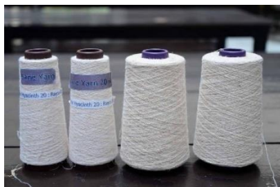
ภาพที่ 2 เส้นด้ายจากผักตบชวาสำหรับนำไปทอเป็นผืนผ้าเส้นพุ่ง : มหาวิทยาลัยเทคโนโลยีราชมงคลธัญบุรี, 2559
