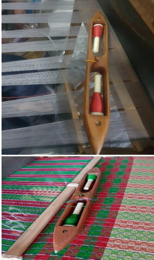
ภาพที่ 9 กระสวยเรือ สำหรับใส่ด้ายพุ่ง เส้นใยขนาดเล็ก
