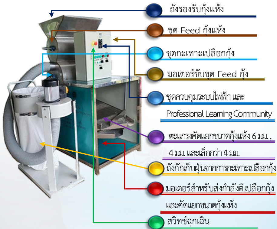
ภาพที่ 10 เครื่องกะเทาะเปลือกและคัดแยกขนาดกุ้งแห้ง
