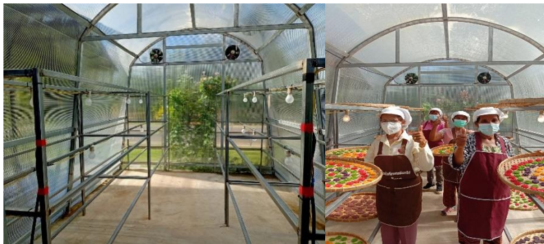
ภาพที่ 4.4 ผลการติดตั้งโรงอบแห้งขนมนางเล็ดด้วยพลังงานแสงอาทิตย์
