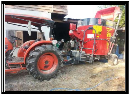
ภาพที่ 13 เครื่องผสมอาหาร TMR เคลื่อนที่
