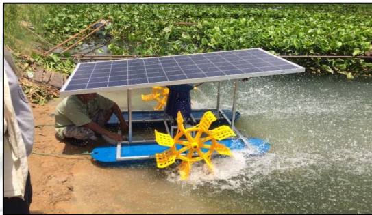
ภาพที่ 2 การทำงานของกังหันน้ำพลังงานแสงอาทิตย์
