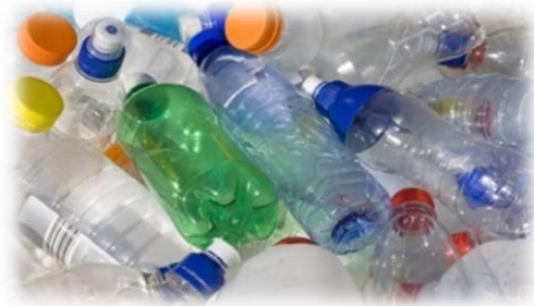
ภาพที่ 2.8 พลาสติกที่สามารถนำกลับมาใช้ใหม่ได้หรือเทอร์โมพลาสติก
