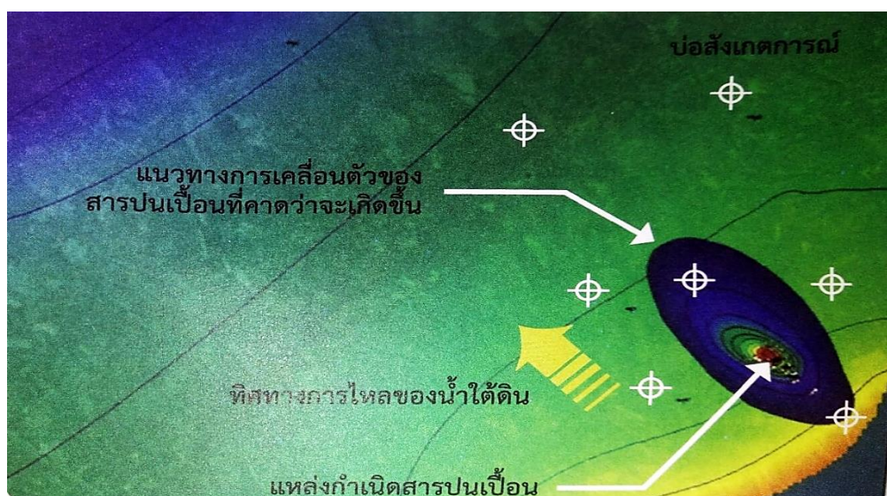
ภาพที่ 15 การวางตำแหน่งบ่อติดตามตรวจสอบสำหรับการเฝ้าระวังและติดตามการปนเปื้อน (กรมโรงงานอุตสาหกรรม, 2559a)
