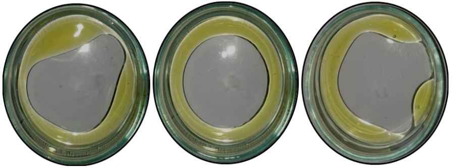
ภาพที่ 11 แสดงการทดสอบประสิทธิภาพของสารลดแรงตึงผิว ทางชีวภาพโดยวัดค่าการกระจายของน้ำมัน
