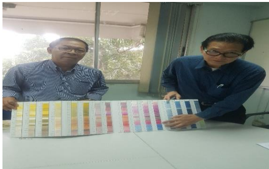
ภาพที่ 23 การเลือกเฉดสีของเส้นด้ายยืนให้เหมาะสม กับเส้นด้ายพุ่ง
