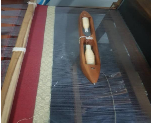
ภาพที่ 11 กระสวยเรือ สำหรับเส้นด้ายพุ่งสับปะรด
