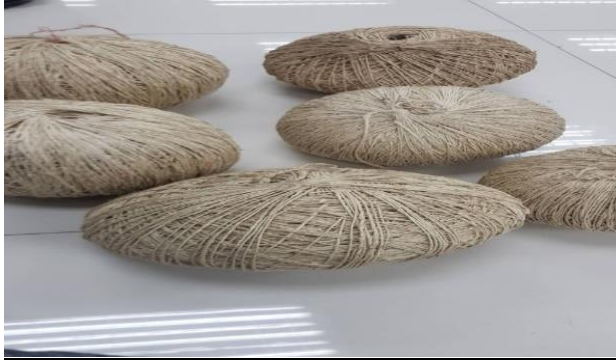
ภาพที่ 7 เส้นใยสับปะรดที่ได้ตีเกลียวและม้วนเตรียมสร้าง
