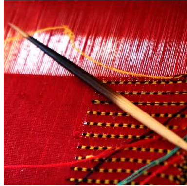
ภาพที่ 43 คนเม่นหรือไม้ปลายแหลม [ที่มา: 16]
