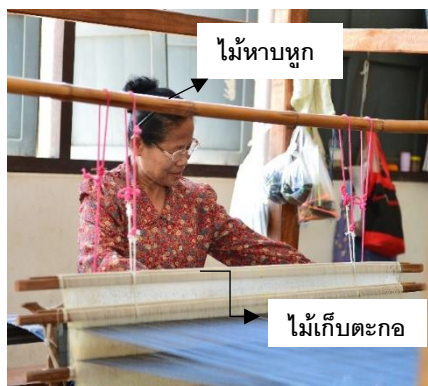
ภาพที่ 36 ไม้เก็บตะกอก และไม้หาบหูก
