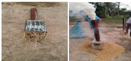
ภาพที่ 38 การใส่ฟางข้าวเพื่อเป็นเชื้อเพลิงในการเผา และการจุดไฟภายในปิ๊บ
