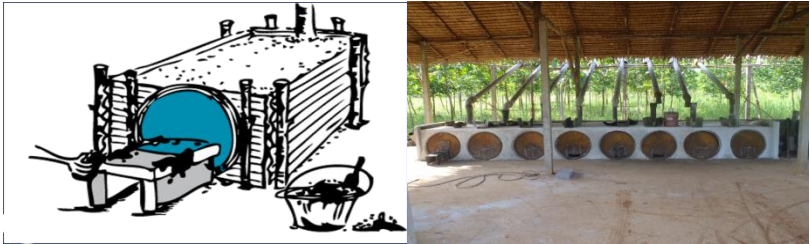
ภาพที่ 16 การปิดเตา และทำช่องอากาศ
