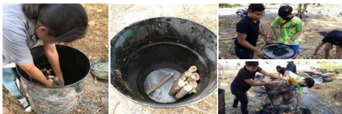
ภาพที่ 32 การบรจวัสดุที่จะผลิตถ่านชีวภาพลงในถังเหล็กขนาด 50 ลิตร
