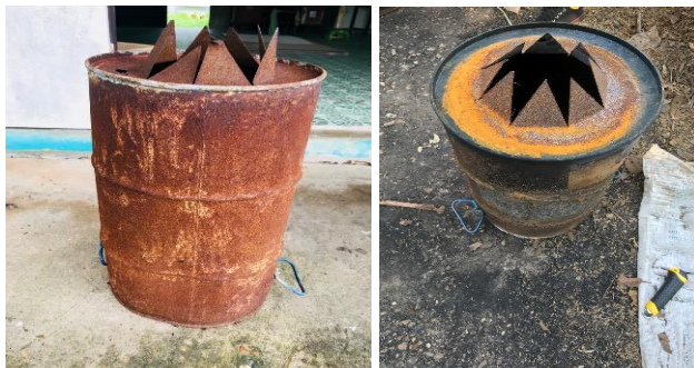
ภาพที่ 30 ถังเหล็กแบบยาว ขนาด 50 ลิตร สำหรับเป็นท่อระบายควัน
