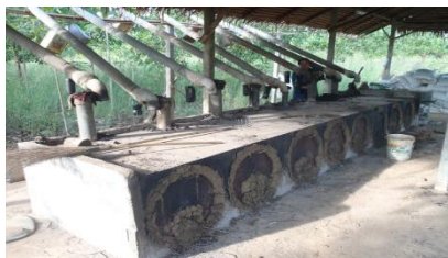
ภาพที่ 20 การปิดหน้าเตาด้วยดินเหนียวเมื่อควันกลายเป็นสีน้ำเงิน
