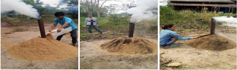
ภาพที่ 39 ขั้นตอนเทแกลบรอบ ๆ ปีบ และต้องคอยเฝ้าให้เกิดการไหม้ที่ทั่วถึง
