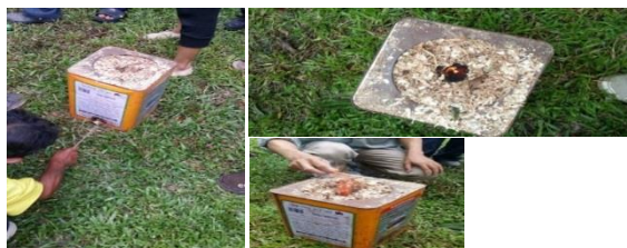
ภาพที่ 27 การจุดเตา และการเผาไหม้ของเตาแบบชั้นเดียว
