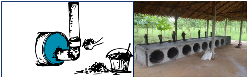
ภาพที่ 14 การต่อข้ออและใช้ดินโคลนหรือปูนยารอยต่อระหว่างถังกับข้ออ และข้ออกับท่อตรง
