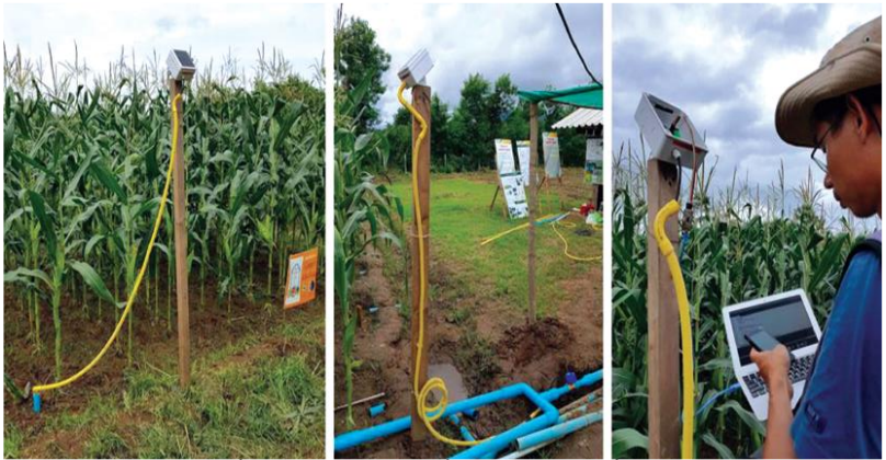
ภาพแสดง การติดตั้งชุดตรวจวัดความชื้น และควบคุมน้ำในแปลงปลูกข้าวโพด
