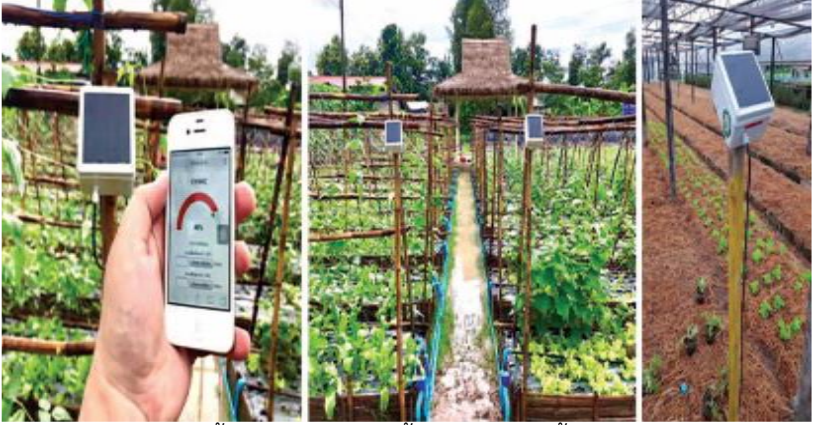
ภาพแสดง การติดตั้งชุดตรวจวัดความชื้น และควบคุมน้ำในแปลงปลูกผัก
