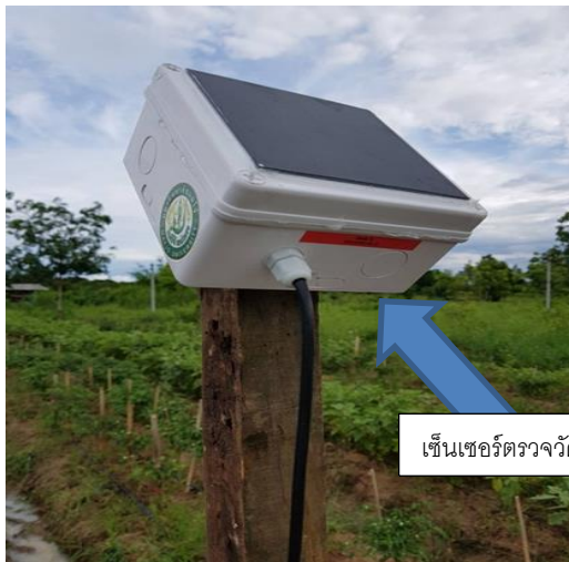
ภาพแสดง จุดติดตั้งเซ็นเซอร์ตรวจวัดความชื้นในพื้นที่แปลงปลูก
