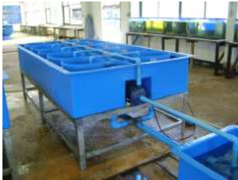
ภาพที่ 7 ระบบถังลงเกาะและอนุบาลลูกหอยนางรมแบบน้ำหมุนเวียนกึ่งปิด
