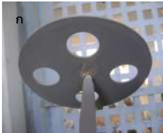
ภาพที่ 5 อุปกรณ์ที่ใช้สูมน้ำปริมาณลูกหอย (ก) แท่งกวน และ (ข) สไลด์นับแพลงก์ตอนสัตว์
