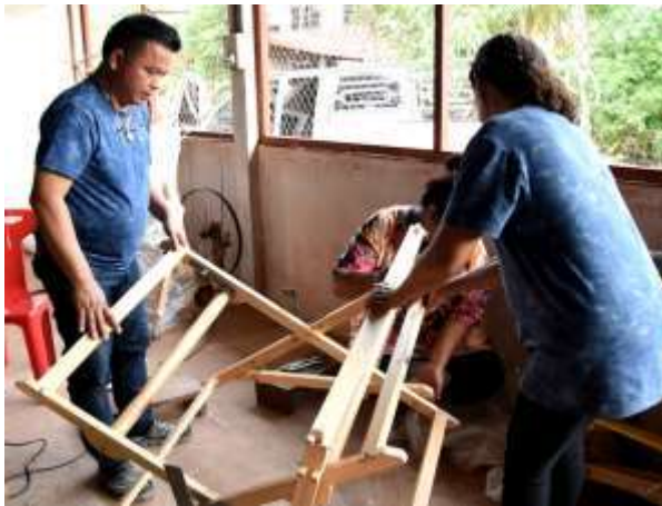
รูปที่ 2.1 กางเครื่องทอผ้าแบบพกพา เพื่อเตรียมประกอบ
