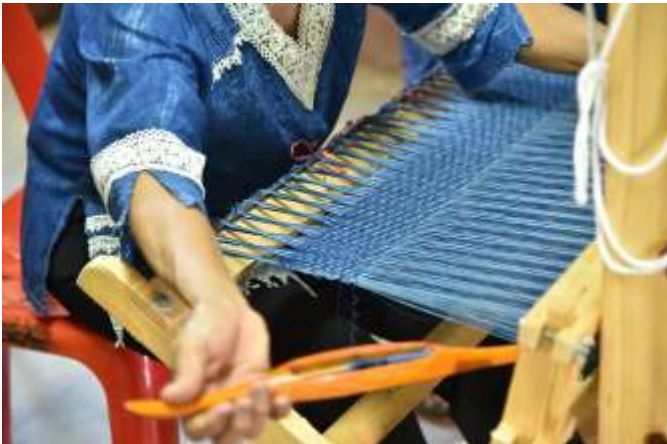
รูปที่ 4.19 การเตรียมเส้นพุ่งใส่กระสวยเพื่อทอ
