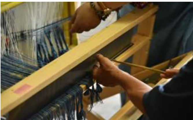
รูปที่ 4.18 แสดงการตีเส้นยืนจากหัวม้วนโดยผ่านฟันหรี (พิมพ์)
