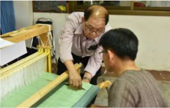
รูปที่ 5.3 แสดงการตรวจเช็คเส้นยืนก่อนการทอ
