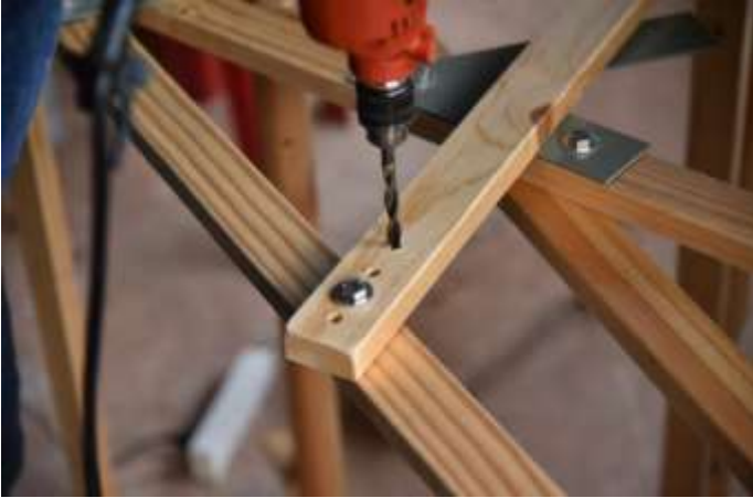
รูปที่ 2.8 เจาะรู เพิ่มระดับสูงต่ำในการตั้งไม้กระทบพื้นหวี
