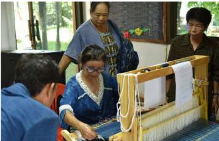
รูปที่ 4.23 การจัดเรียงเส้นพุ่งเพื่อเตรียมการทอ
