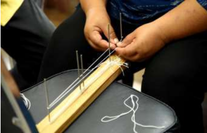
รูปที่ 4.1 แสดงการผูกตะกอบบนแม่พิมพ์ไม้
