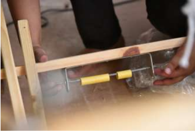
รูปที่ 2.12 การติดตั้งเท้าเหยียบและหาระยะที่วางเท้าเหยียบ
