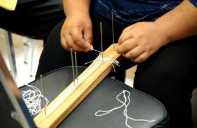
รูปที่ 4.5 แสดงการผูกตะกอลเพื่อให้เกิดข้อรูตะกอเท่า ๆ กัน
