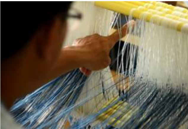
รูปที่ 4.14 การเก็บตะกอจากตะกอที่ 1 ไปตะกอที่ 4 ตามลำดับ
