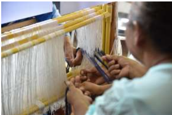
รูปที่ 4.12 การสับตะกอจากเส้นยืนโดยเรียงลำดับ จากด้านใดด้านหนึ่ง
