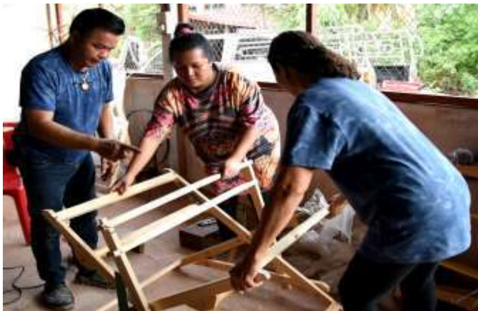
รูปที่ 2.3 ยึดคานด้านล่างด้วยน็อตและปรับองศาให้ได้สัดส่วน
