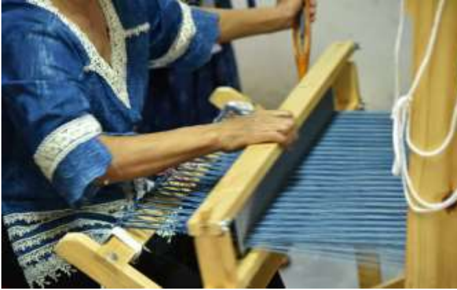
รูปที่ 4.22 การดึงเส้นด้ายพุ่งแล้วกระทบหน้าฟืม
