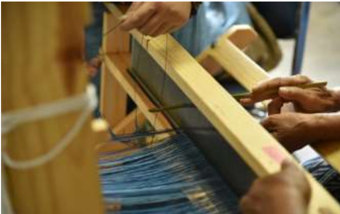
รูปที่ 4.16 การร้อยฟันหวีโดยกัวกเส้นด้ายให้ผ่านฟืมทุกช่อง
