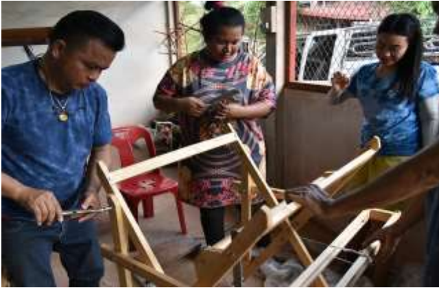
รูปที่ 2.4 หมุนน็อตพร้อมยึดแกนเครื่องทอผ้าแบบพกพา ด้วยน็อตตามรูป
