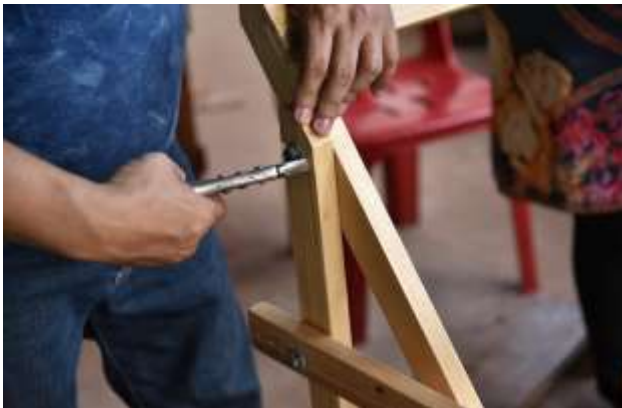
รูปที่ 2.5 สกรูน็อตให้แข็งแรงประกอบทั้ง 4 ด้าน ของเครื่องทอผ้าแบบพกพา
