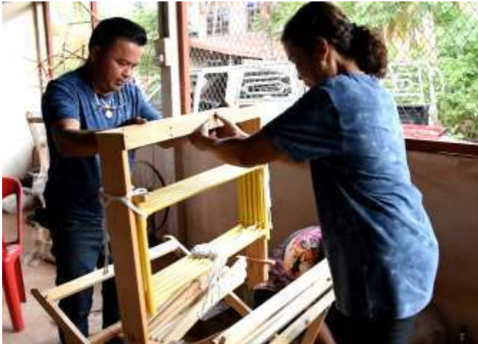
รูปที่ 2.9 ตั้งเสาตะกอก โดยยึดให้ได้ระดับตามแนวนอน
