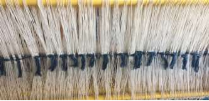
รูปที่ 4.15 แสดงการร้อยตะกอกผ่านเส้นยืนเป็นชุดเส้นยืน
