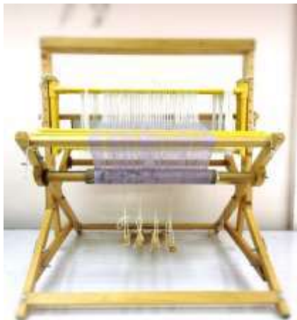
รูปที่ 1.3 เครื่องทอผ้าแบบพกพามองจากด้านหลัง
