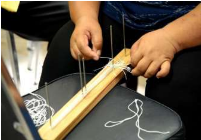
รูปที่ 4.5 แสดงการผูกตะกอลเพื่อให้เกิดข้อรูตะกอเท่า ๆ กัน
