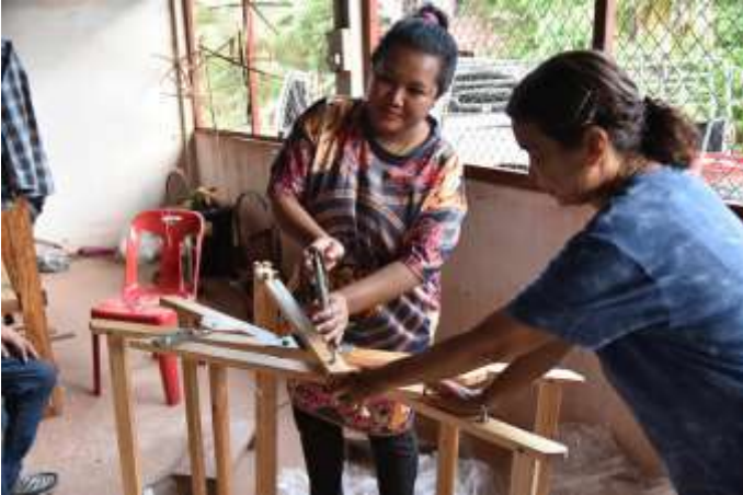
รูปที่ 2.6 ยึดน็อตคั่นโยกพีมด้านบนและด้านล่าง
