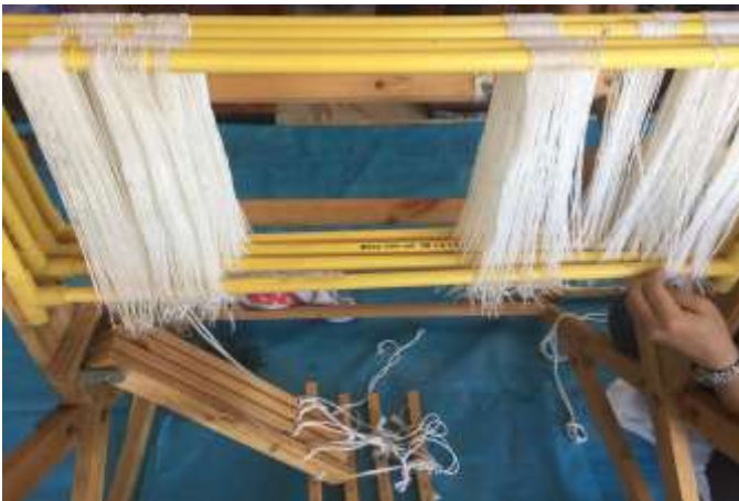
รูปที่ 4.8 นำตะกอกที่ผูกเสร็จมาเรียงลำดับเข้าตะกอพลาสติก
