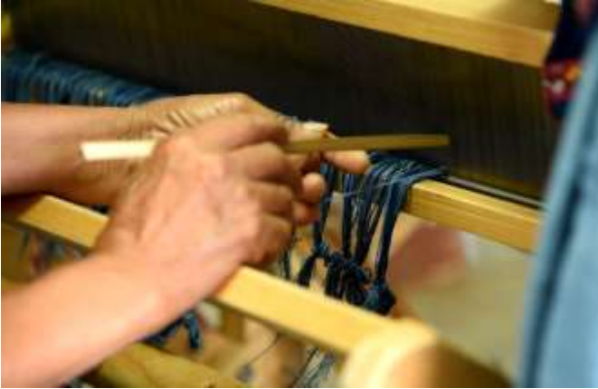
รูปที่ 4.17 แสดงการทักเส้นด้ายจากร่องฟันหรีทุกช่อง
