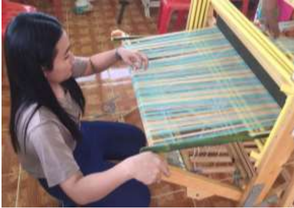
รูปที่ 4.11 การม้วนเส้นยืนเข้าเครื่องทอผ้าแบบพกพา ด้วยเฟืองหมุน
