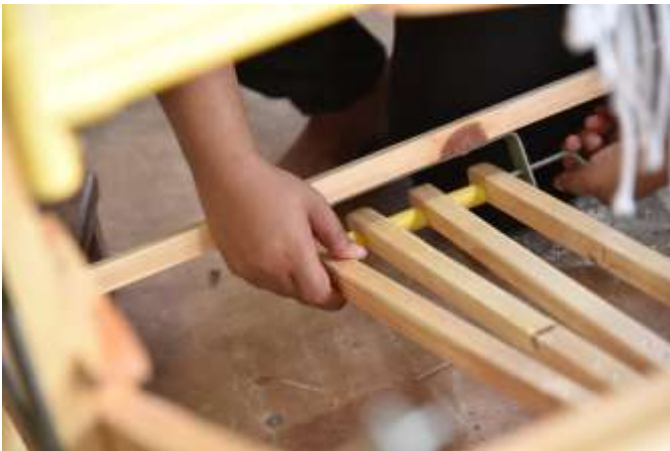
2.15 การล๊อคแกนเท้าเหยียบด้วยแกนเหล็ก
