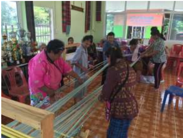
รูปที่ 4.9 การค้นเครื่องเส้นยืนบนกี่ทอผ้าแบบพกพา
