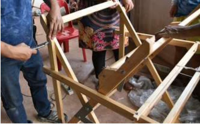
รูปที่ 2.2 ปรับขาเครื่องทอผ้าแบบพกพาให้ได้สัดส่วน และยึดด้วยน็อตตามรูป
