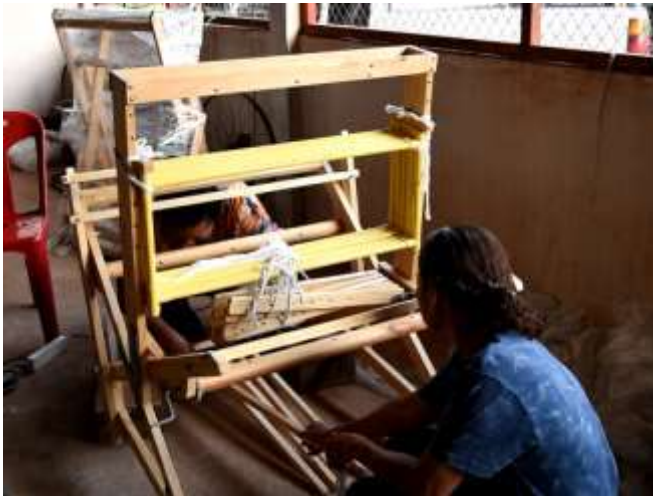
รูปที่ 2.13 ติดตั้งเท้าเหยียบโดยโยงกับสายดึงตะกอ
