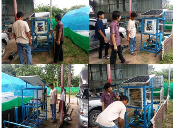
ภาพที่ 3.7 เทคโนโลยีการสูบน้ำเพื่อการเกษตรด้วยพลังงานแสงอาทิตย์
