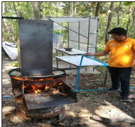
รูปที่ 28 เปิดน้ำเข้าสู่ระบบแลกเปลี่ยนความร้อน
