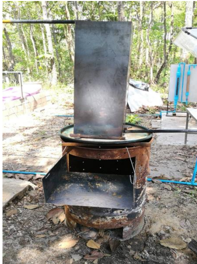
รูปที่ 26 เตาผลิตน้ำร้อนจากเชื้อเพลิงชีวมวล
