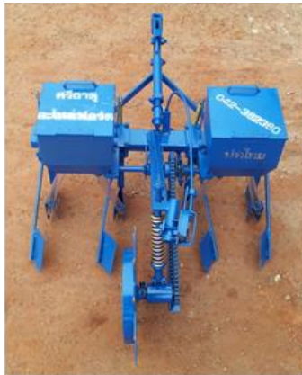
ค Direct seeding machine โดยใช้รถไถเดินตามลาก
