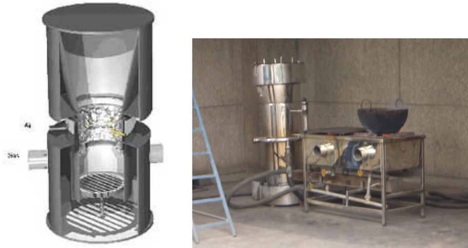
รูปที่ 40 เตาผลิตแก๊สชีวมวลแบบอากาศไหลลง (Downdraft or Counter-current Gasifier)
