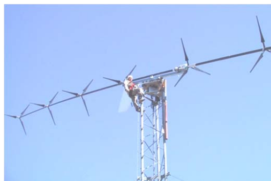
รูปที่ 19 กังหันแบบแกนนอน แบบกังหันหลายตัวอยู่บนเสารองรับเดียว
