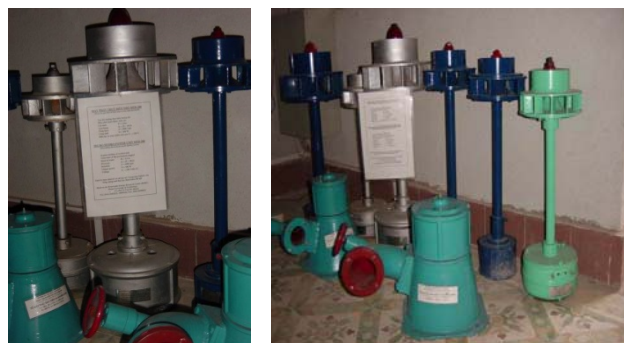
รูปที่ 11 ระบบผลิตไฟฟ้าพลังงานน้ำ Pico – hydro
