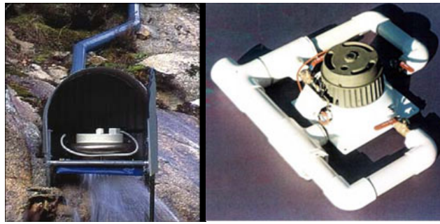
รูปที่ 12 ระบบผลิตไฟฟ้าพลังงานน้ำ Micro – hydro
