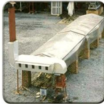
รูปที่ 36 ตู้อบพลังงานแสงอาทิตย์ร่วมกับชีวมวล
