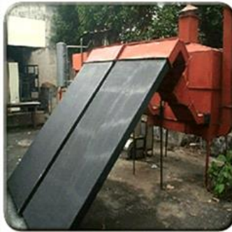
รูปที่ 36 ตู้อบพลังงานแสงอาทิตย์ร่วมกับชีวมวล
