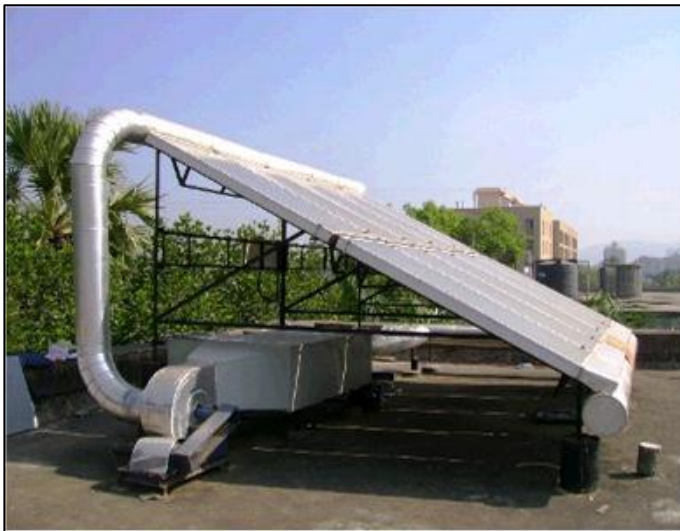
รูปที่ 34 เครื่องอบแห้งแบบใช้แผงรับความร้อนโดยใช้พัดลมดูดอากาศร้อน
