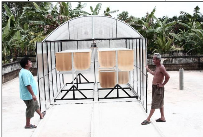
รูปที่ 33 ห้องอบแห้งพลังงานแสงอาทิตย์สำหรับยางพาราและอาหารทะเล
