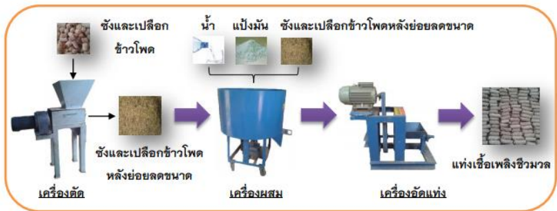
รูปที่ 8 วัสดุและอุปกรณ์สำหรับการผลิตแท่งเชื้อเพลิงชีวมวล
