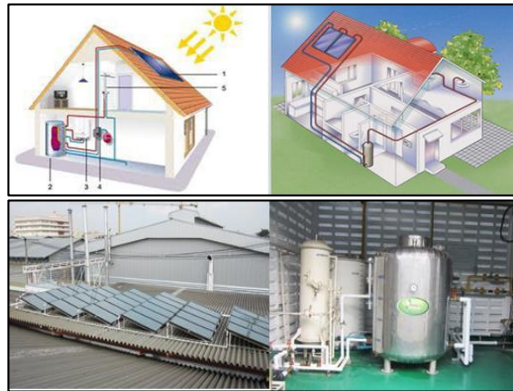
รูปที่ 6 เครื่องผลิตน้ำร้อนชนิดใช้ปั๊มน้ำหมุนเวียน
