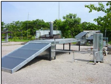
รูปที่ 31 ตู้อบพลังงานแสงอาทิตย์แบบมีแผ่นรับแสงอาทิตย์เสริม
