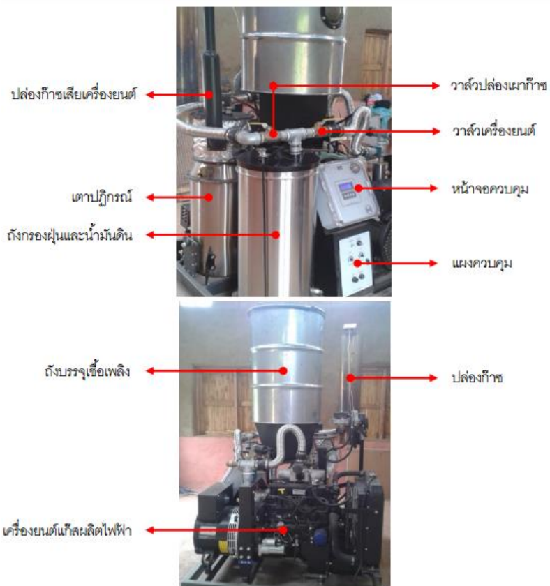
รูปที่ 10 ส่วนประกอบของเตาแก๊สซีไฟเออร์แบบก๊าซไหลลง
