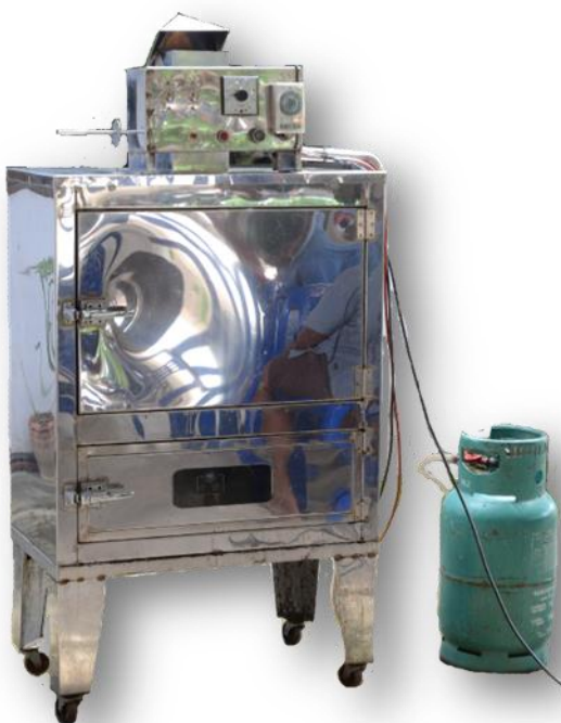
รูปที่ 6 เครื่องอบแห้งด้วยการแผ่รังสีอินฟราเรดระยะไกลของเซรามิก
