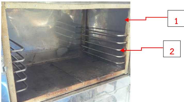
1 ผนังห้องอบแห้ง 2 ชั้นสำหรับวางถาดวัตถุดิบ
