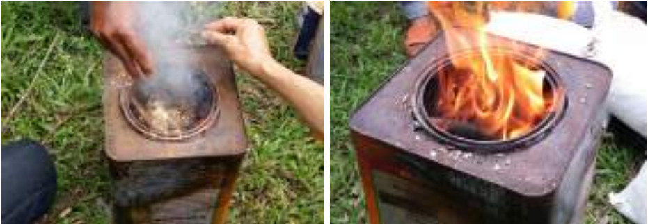
ภาพที่ 13 การเติมเชื้อเพลิงจากเศษพืช และการลุกไหม้ของเชื้อเพลิงจากเตาชีวมวล
