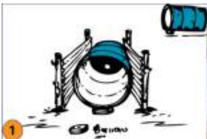
ภาพที่ 3 การวางถังขนาด 200 ลิตร
