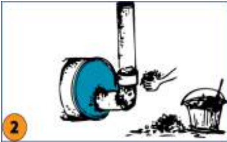
ภาพที่ 4 การต่อข้ออและใช้ดินโคลนหรือปูนยารอยต่อระหว่างถังกับข้ออ และข้ออกับท่อตรง
