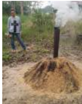
ภาพที่ 33 การเผาถ่านแกลบที่ต้องคอยเขี่ยให้เกิดการไหม้ที่ทั่วถึง
