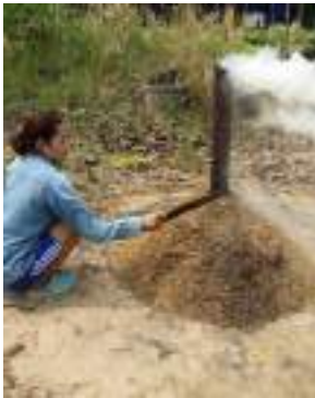
ภาพที่ 33 การเผาถ่านแกลบที่ต้องคอยเขี่ยให้เกิดการไหม้ที่ทั่วถึง
