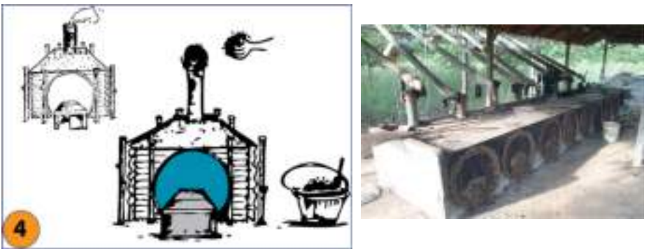
ภาพที่ 10 การปิดหน้าต่างด้วยดินเหนียวเมื่อควันกลายเป็นสีน้ำเงิน
