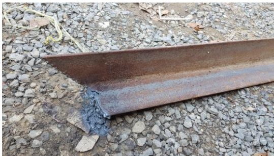
ภาพที่ 3.22 ตัวอย่างการใช้ก๊าซชีวภาพในการตัดเหล็ก
