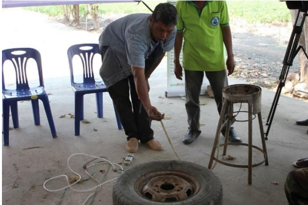
ภาพที่ 3.21 ตัวอย่างการเก็บก๊าซชีวภาพในยางรถยนต์เพื่อนำไปใช้ออกสถานที่
