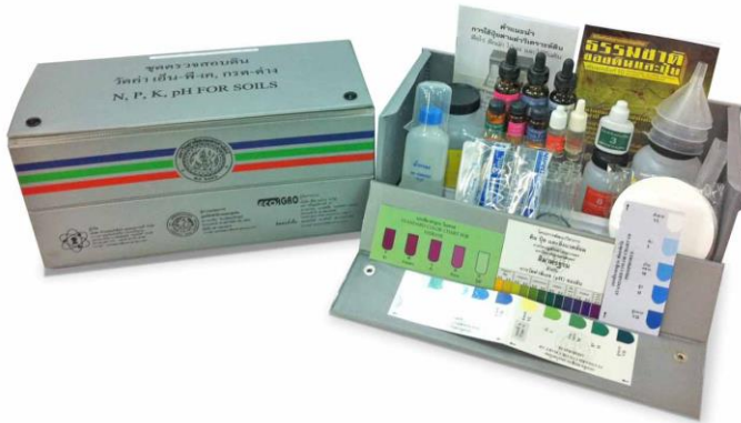
ภาพที่ 1.4 ชุดตรวจสอบ เอ็น พี เค และ พีเอช ในดิน
