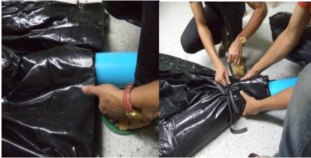
รูปที่ 12. มัดประกอบถุงหมักพีวีซีเข้ากับท่อพีวีซี
