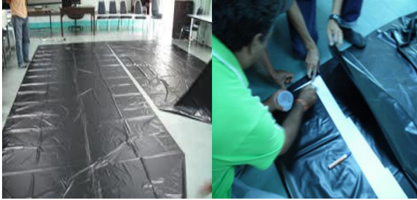
รูปที่ 10. การตัดและการทากาวพลาสติกแอลดีพีอี
