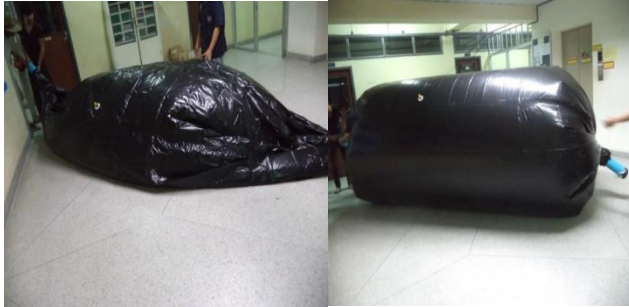
รูปที่ 13. เป่าลมทดสอบบรอยรั่ว
