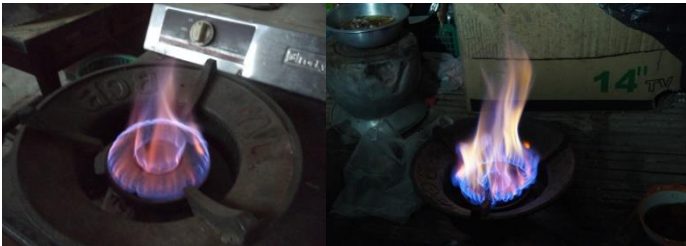
รูปที่ 20. ก๊าซจะจุดติดไฟหลังจากการเติมมูลไม่เกิน 20 วัน
