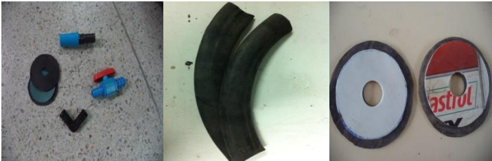
รูปที่ 5. เกลียวนอก-ในพีวีซี,ยางในรถและพลาสติกแข็ง
