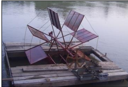
รูปที่ 2 กังหันน้ำตัวที่ 2 มีใบตรง 8 ใบ
