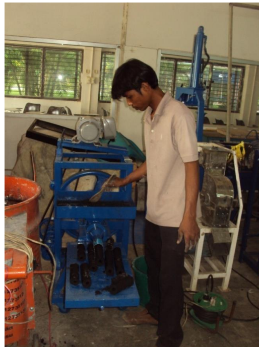
ภาพที่ 43 การอัดแท่งถ่านอัดแท่งด้วยเครื่องอัดแบบเกลียว (Screw press)
