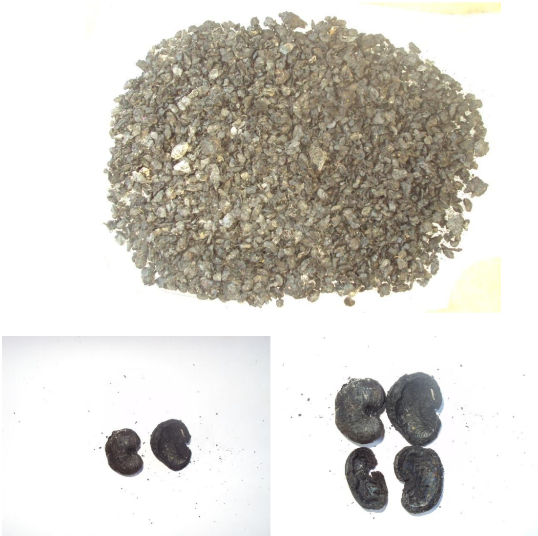
ภาพที่ 37 ลักษณะถ่านเปลือกมะม่วงหิมพานต์ที่เหลือจากการเผาโดยใช้เตาเผาเปลือกมะม่วงหิมพานต์แบบประสิทธิภาพสูง (เทคโนโลยีแก๊สซิไฟเออร์แบบเชื้อเพลิงนิ่ง หรือ Fixed bed Gasifier)
