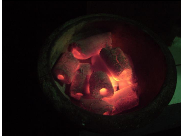
ภาพที่ 52 ถ่านเชื้อเพลิงถ่านอัดแท่งจากเปลือกมะม่วงหิมพานต์ที่ติดไฟหลังจากหลังจากติดไฟแล้ว 15 นาที
