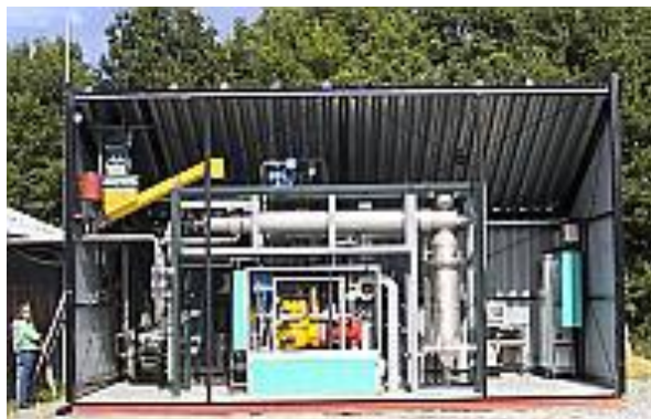
ภาพที่ 13 ลักษณะเตาผลิตแก๊สแบบฟลูอิดซ์เบด (ที่มา : Breag and Chitten, 1979)
