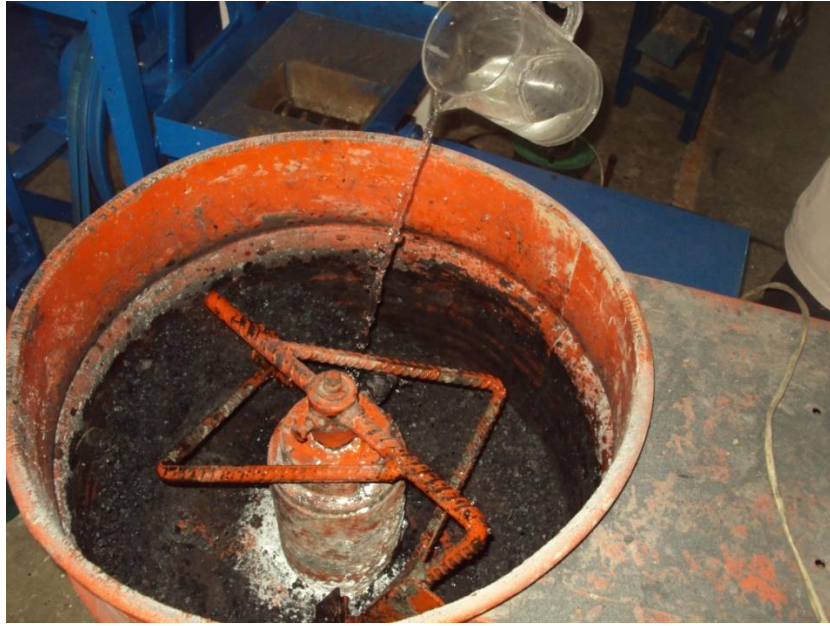
ภาพที่ 41 การผสมตัวประสาน (น้ำ) ลงไปในถังผสม
