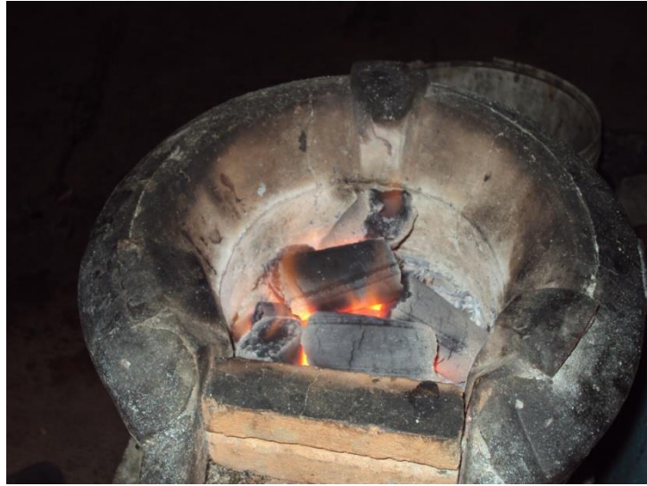
ภาพที่ 52 ถ่านเชื้อเพลิงถ่านอัดแท่งจากเปลือกมะม่วงหิมพานต์ที่ติดไฟหลังจากหลังจากติดไฟแล้ว 15 นาที
