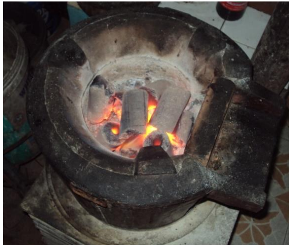
ภาพที่ 55 ถ่านเชื้อเพลิงถ่านอัดแท่งจากเปลือกมะม่วงหิมพานต์ที่เริ่มมอดไฟ (หลังจากการเผาไหม้)
