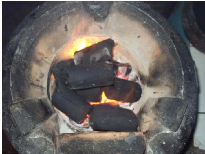
ภาพที่ 51 ถ่านเชื้อเพลิงถ่านอัดแท่งจากเปลือกมะม่วงหิมพานต์ที่เริ่มติดไฟ
