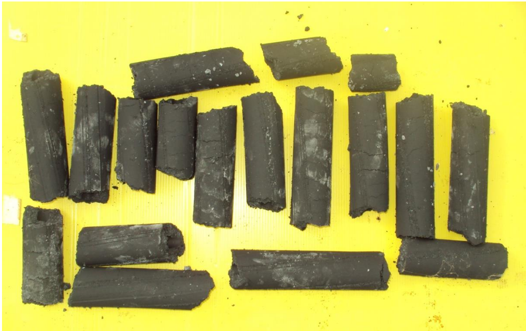
ภาพที่ 44 ลักษณะของถ่านอัดแท่งด้วยเครื่องอัดแบบเกลียว (Screw press)
