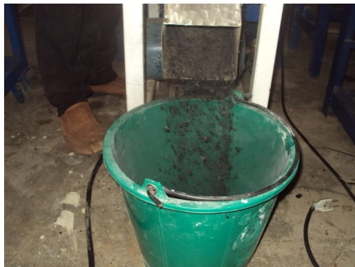
ภาพที่ 38 การบดถ่านเปลือกมะม่วงหิมพานต์ให้เป็นผงละเอียด
