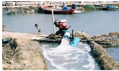
ภาพที่ 1. เครื่องสูบน้ำทะเลที่ใช้ในการชักน้ำทะเลจากคลองธรรมชาติเข้าสู่บ่อเก็บกักน้ำทะเล
