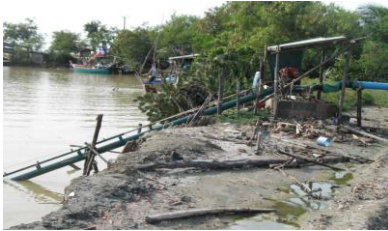
ภาพที่ 1. เครื่องสูบน้ำทะเลที่ใช้ในการชักน้ำทะเลจากคลองธรรมชาติเข้าสู่บ่อเก็บกักน้ำทะเล
