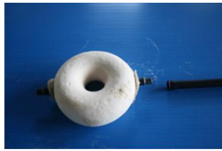
② ต่อเซรามิกเข้ากับสายไมโครฟิอิต์ทั้ง 2 ด้าน
