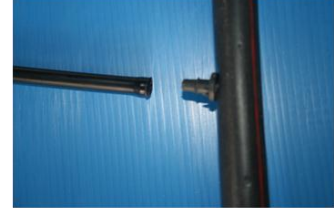
③ นำปลายสายไมโครพื่ออีกด้านหนึ่งต่อเข้ากับท่อพื่อ
