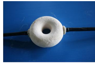
การต่อเซรามิกเข้ากับสายไมโครฟิอิต์ทั้ง 2 ด้าน
