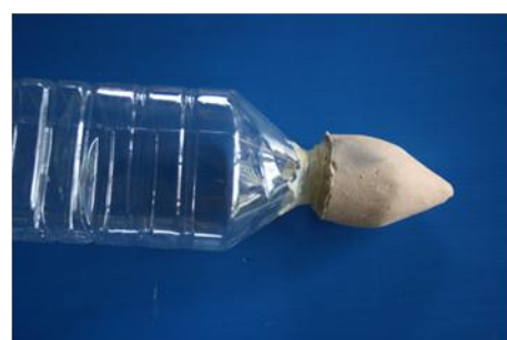
② นำเซรามิกรูพรุนมาต่อกับขวดน้ำเปล่า
