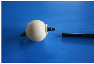
2 ต่อเซรามิกเข้ากับสายไมโครพีอี ทั้ง 2 ด้าน
