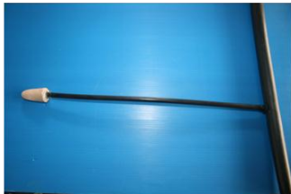
④ ลักษณะการต่อเซรามิกรูพรุนทรงกรวยเล็กเข้ากับระบบน้ำจากท่อพีอี
