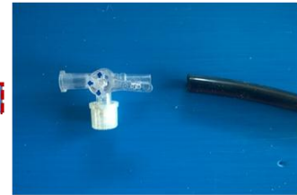
③ ต่อสายไมโครฟิอิต์ด้านปลายเข้ากับวาล์วสามทาง
