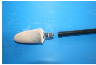
② นำเซรามิกรูพรุนต่อเข้ากับสายไมโครพีอี
