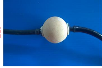
การต่อเซรามิกเข้ากับสายไมโครพีอี 2 ด้าน
