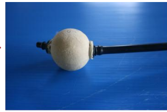
การต่อเซรามิกเข้ากับสายไมโครพีอี ด้านเดียว
