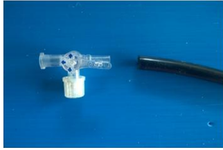
3 ต่อสายไมโครพีอีด้านปลายเข้ากับ วาล์วสามทาง
