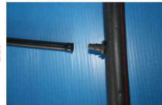
③ นำปลายสายไมโครพีอีอีกด้านหนึ่งต่อเข้ากับท่อพีอี
