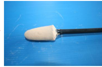
เซรามิกรูพรุนทรงกรวยเล็กต่อกับสายไมโครพีอี
