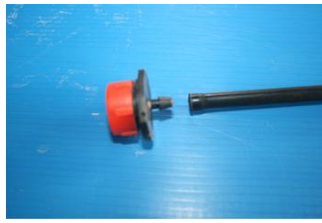
② ต่อหัวน้ำหยดเข้ากับสายไมโครพื่อ
