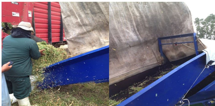
รูปที่ 6 เครื่องลำเลียงและอัดเข้าสู่ถูงหมัก
