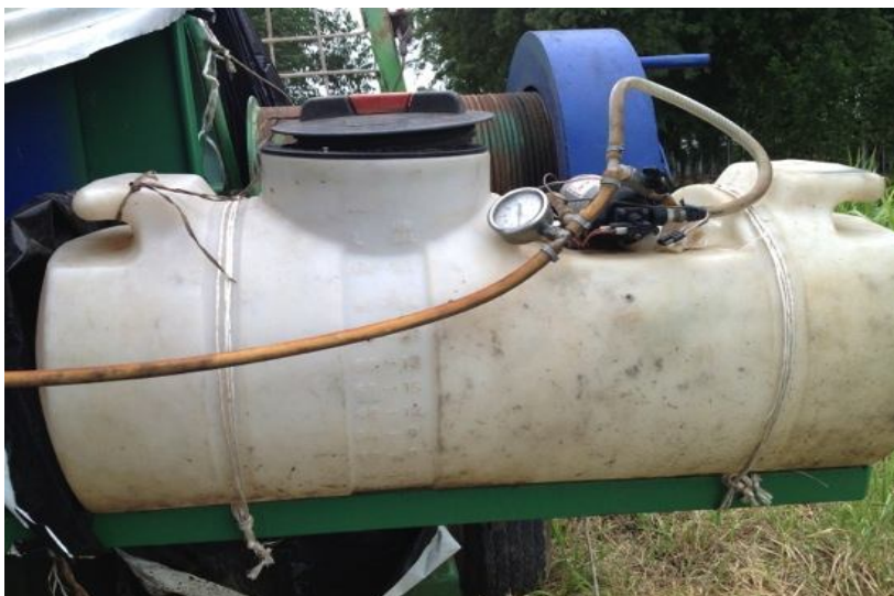
รูปที่ 5 เครื่องพ่นสารละลายหัวเชื้อ
