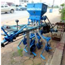
ภาพที่ 5 เครื่องหยอดข้าวแห่งมิตรรถไถนาเดินตาม
