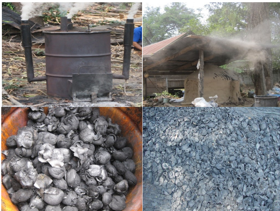
ภาพถ่านเปลือกตาลและข้าวตาลอ่อน และถ่านกะลาตาล
