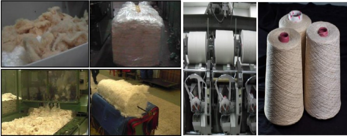
ภาพการผสมและทำแผ่นม้วนเส้นใย ในระบบปั่นเส้นด้ายแบบ open- end spinning
