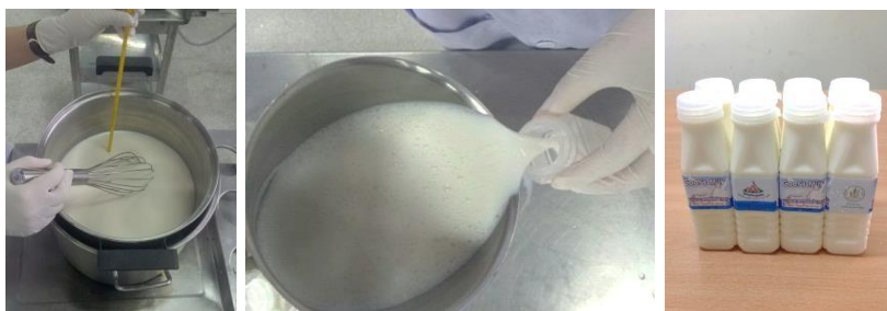
รูปที่ 5 ขั้นตอนการผลิตนมแพะพาสเจอร์ไรส์แบบคริวเรื่อน
